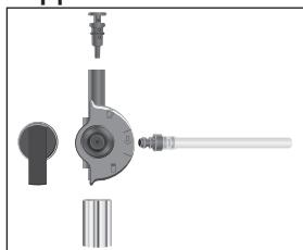
► Легким вращательным движением осторожно снимите устройство для приготовления капучино с системы Connector System®.
