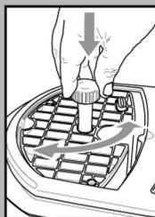
Аппарат позволяет легко настраивать кофемолку, чтобы лучше всего адаптироваться под вкус пользователя. Настройку надо производить с помощью регулятора внутри отсека для зерен; надо надавить на регулятор и повернуть его с помощью специального ключа в комплекте.
