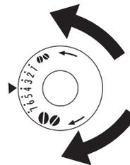
Для обеспечения более медленной подачи кофе и улучшения вида пенки поверните ручку на деление против часовой стрелки (более мелкий помол).
