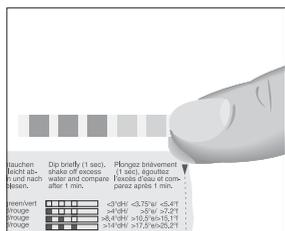
Жесткость воды можно определить с помощью тест-полоски Aquadur®, входящей в комплект поставки.
