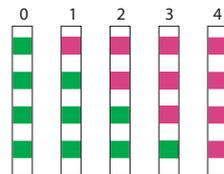
Классы жесткости воды для начальной настройки электроприбора (раздел 3.2)
