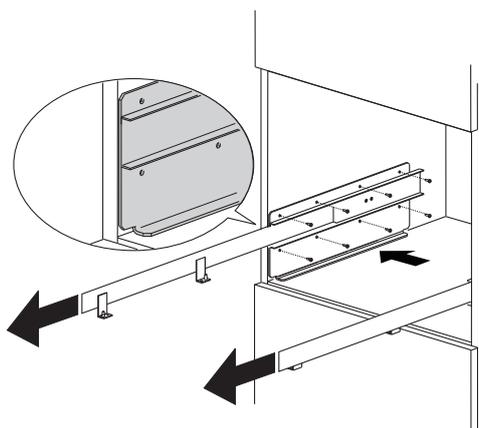
Установите направляющие на стенках стойки, как показано на рисунке. Закрепите направляющие соответствующими прилагаемыми винтами, затем их полностью выдвиньте. В случае, если кофемашина установлена на прибор для разогрева напитков, используйте ее верхнюю поверхность, как точку отсчета для позиционирования направляющих. В таком случае не надо устанавливать опорную полку
