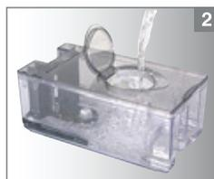
▶ Добавьте средство для удаления накипи в соответствии с инструкциями производителя. Установите резервуар для воды на место.
