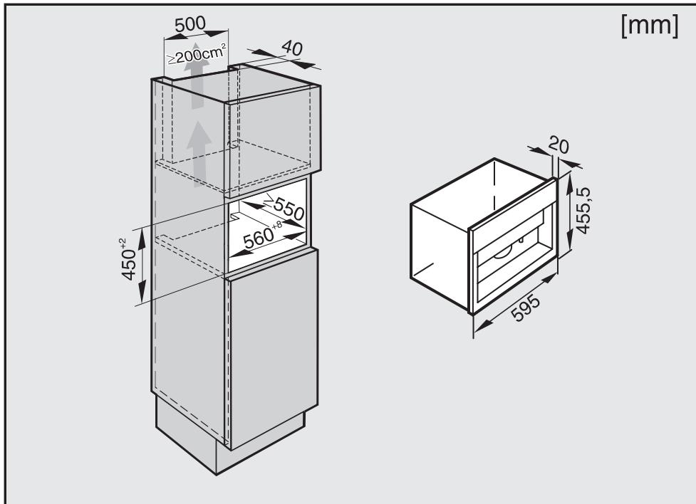
Дизайн и конструкция прибора позволяют его также комбинировать с другой встраиваемой техникой Miele. При этом однако очень важно, чтобы снизу прибор отделялся сплошным промежуточным дном (кроме комбинации со встраиваемым подогревателем посуды).
