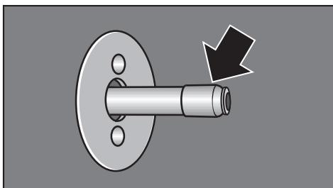
С внутренней стороны дверцы прибора находится деталь, соединяющая устройство заваривания и выпускную насадку.
