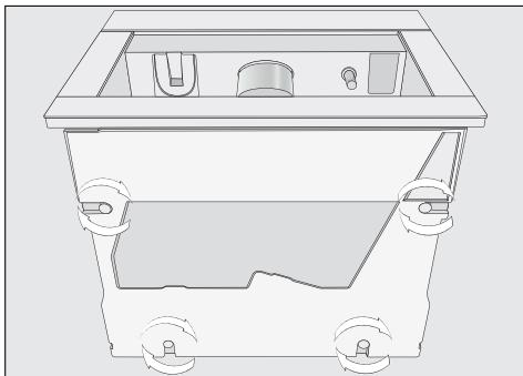
■ Выверните четыре ножки с нижней стороны прибора с помощью большого ключа с внутренним шестигранником прим. на 2 мм.
