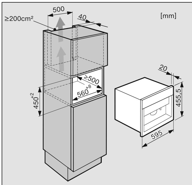
Комбинация с другой встраиваемой техникой Miele возможна. При этом, однако, очень важно, чтобы прибор был отделен снизу закрытым промежуточным дном (кроме комбинации со встраиваемым подогревателем посуды/пищи).
