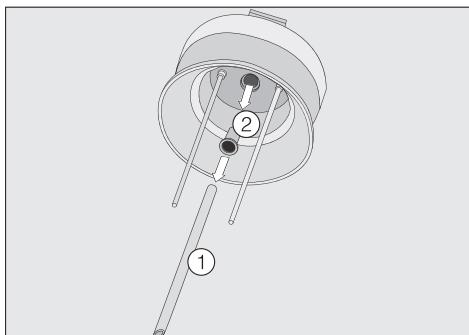
■ Вытяните трубку всасывания молока ① из крышки емкости для молока.
