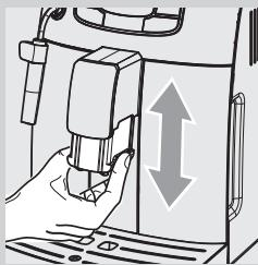
Для выполнения регулировки приподнимите и опустите вручную устройство подачи с помощью пальца, как показано на рисунке.
