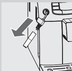
**1** Снимите наружную часть насадки Pannarello. Промойте ее свежей водой.
