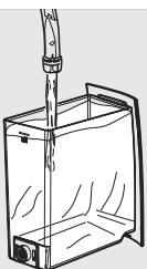
**17** Когда бак для воды опускается, извлеките его, ополосните и наполните свежей водой до указателя уровня MAX. Вставьте его обратно в машину.
