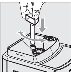
**1** Нажмите и поверните ручку регулирования помола только на одно деление за раз. Разница вкуса будет ощутимой после подачи 2-3 эспрессо.
