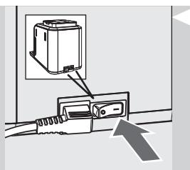
**12** Установите главный выключатель в положение "I", чтобы включить машину. На дисплее появится символ режима ожидания "Stand-By".
