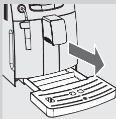
**11** Ополоснуйте блок приготовления кофе, снова вставьте его в гнездо вплоть до фиксации (см. главу "Еженедельная чистка блока приготовления кофе"). Вставьте контейнер для сбора отходов и контейнер для сбора жидких отходов. Закройте дверцу для обслуживания.
