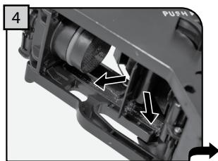
Распределите смазку равномерным слоем на две боковые направляющие.
