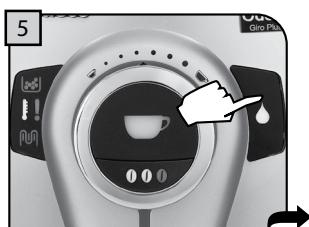
Проверьте, активна ли функция подачи горячей воды. Световой индикатор кнопки должен быть включен. Нажмите на кнопку, чтобы функция подачи горячей воды стала активной.
