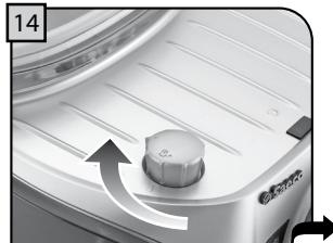
Поверните ручку регулятора в положение ⚧, чтобы слить воду из контейнера для воды.
