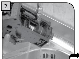
Промойте устройство приготовления водой из-под крана. Хорошо почистите сито.
