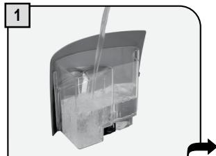
Хорошо промойте контейнер для воды и наполните его свежей питьевой водой до указанной отметки максимального уровня наполнения. Установите контейнер снова.
