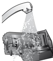
**Belangrijk:** Gebruik bij het reinigen geen spoel- of reinigingsmiddelen en was de zetgroep niet in de vaatwasser.
